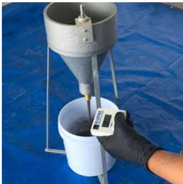
Prueba de fluidez en cono (ASTM C939)
