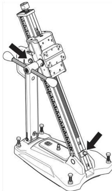
Afloje los tornillos de seguridad de la inclinación de la columna y ajuste como desee el ángulo de inclinación del taladro. Apriete los tornillos de seguridad. Utilice la palanca de alimentación. La columna puede inclinarse 0-60°.
