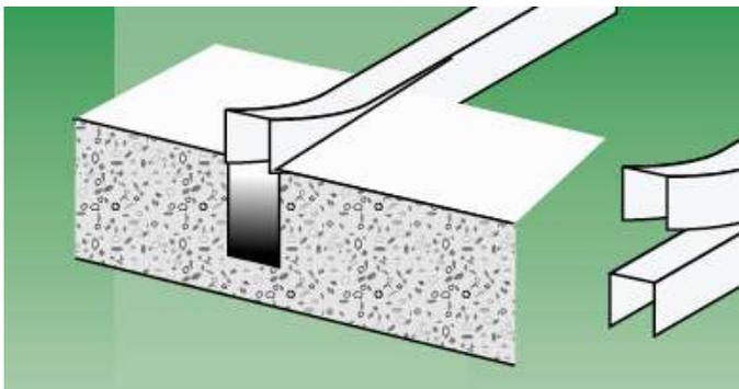
La Tapajunta de Expansión es un perfil plástico cuya finalidad es permitir la inserción de las juntas impregnadas de asfalto Fexpan-celotex, etc. en la parte inferior.
